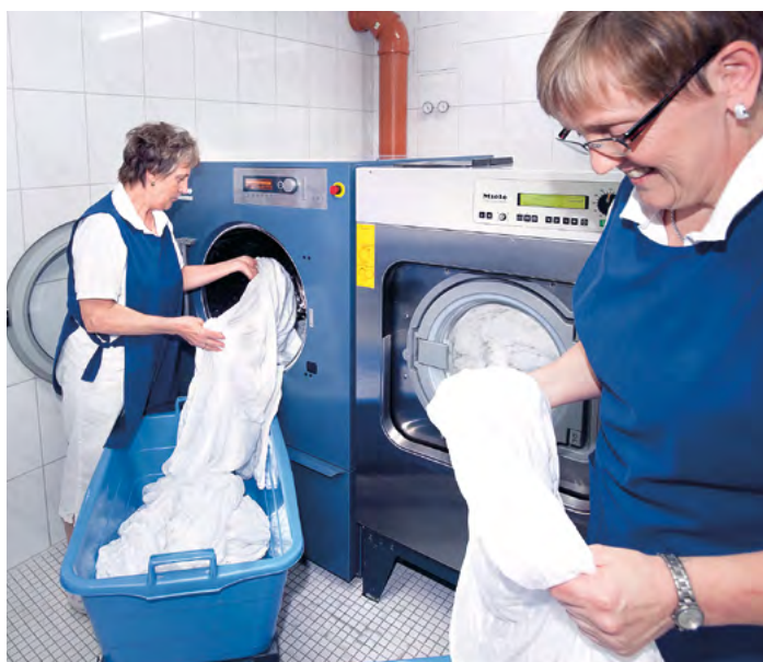
Der H 2 O-Trockner von Miele Professional (links) wird im Hotel Höltje über das heiße Wasser beheizt, das bei der Kühlung des Blockheizkraftwerks ohnehin entsteht.
