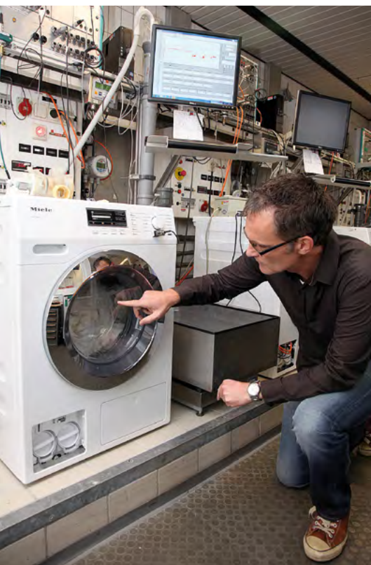
Dirk Sieding erklärt PowerWash im Labor. Die Umflutpumpe befindet sich hinter der linken Verschlusskappe (im Bild unten links).
